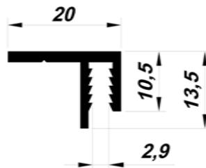
Профиль применяется для монтажа композитных панелей и листовых материалов толщиной 4 мм.
