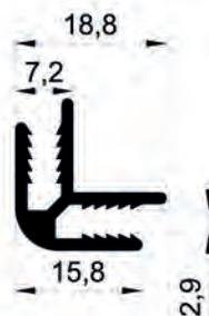
Профиль-шина 19 мм усиленная с 1-м пазом под головку болта М8, овальную гайку 12x25 М6 или М8. Профиль 19 мм применяется для установки в монтажно-фрезерные столы в качестве направляющих шин для перемещения или крепления на них упоров, ограничителей, струбцин, зажимов и других приспособлений. Совместим с профилем-ползуном 13 мм.
